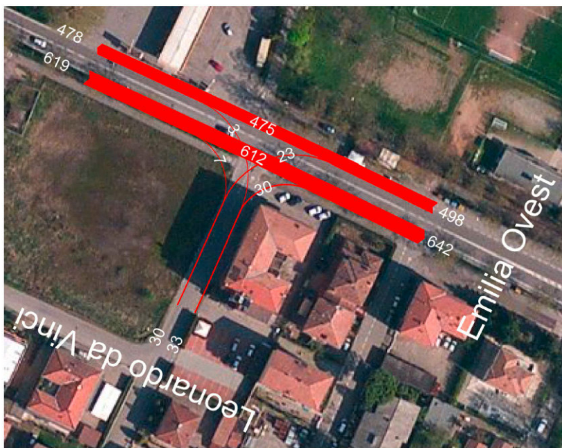
Figura 19. Flussi in traffico in ora di punta serale all'intersezione via Emilia Ovest - via L. da Vinci
