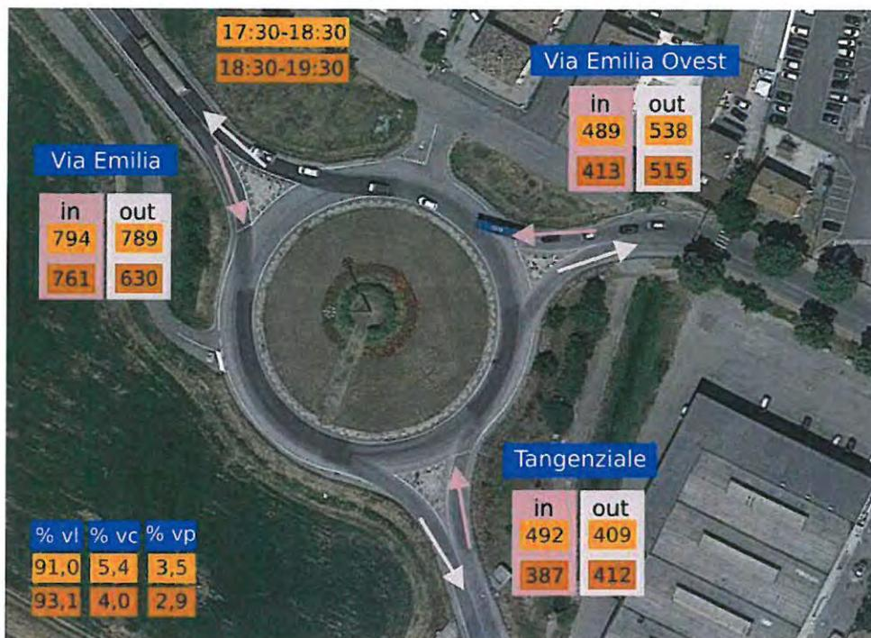
Figura 8 – Analisi dei carichi di traffico rilevati
