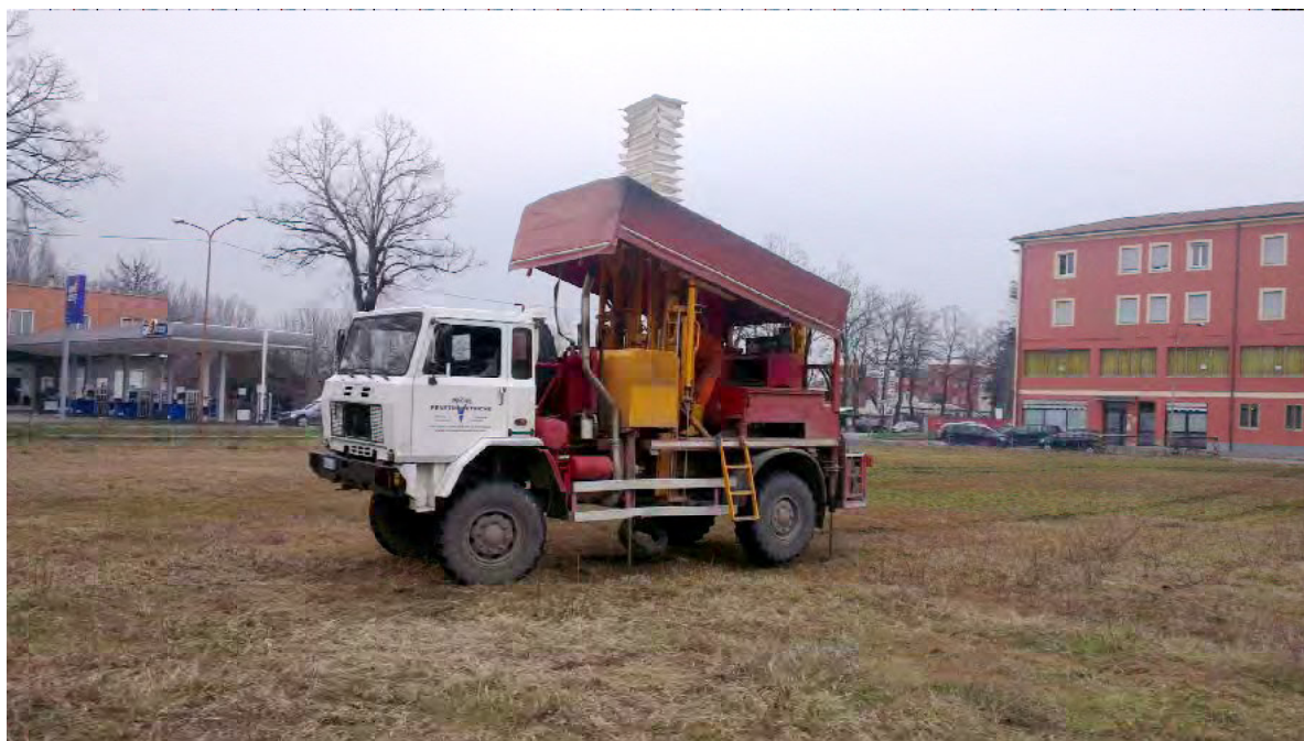
Foto n. 6 – Esecuzione della prova statica CPT mediante penetrometro Pagani 100 KN
