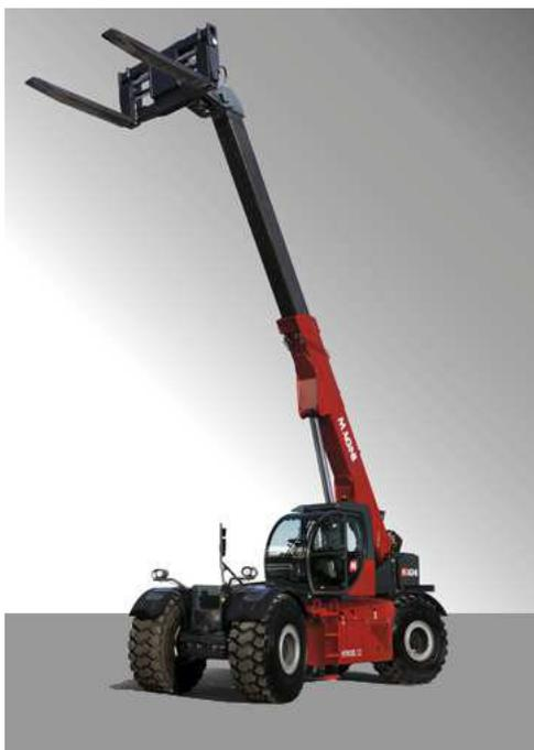
Fig. 3.1.1. Un modello di carrello sollevatore telescopico
