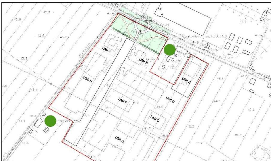
Localizzazione dei punti di misura per il rilievo dei livelli di pressione sonora
