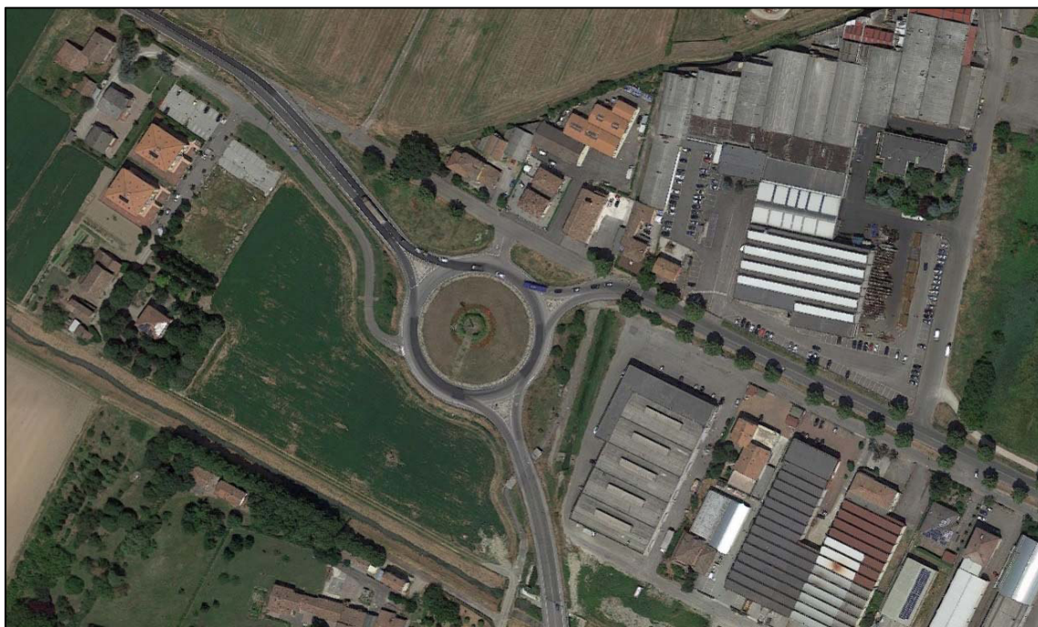
Img. 2.3 - L'intersezione a rotatoria tra la SS n°9 e la Tangenziale sud nello scenario ante operam
