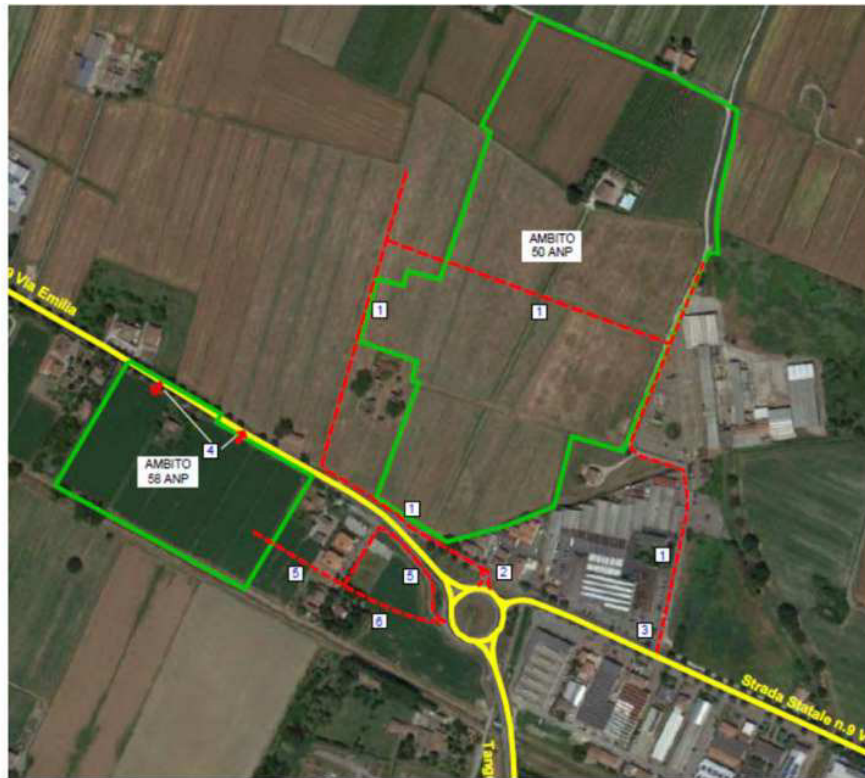
Schema viabilistico di massima per l'accesso ai nuovi ambiti (fonte studio AIRIS)
