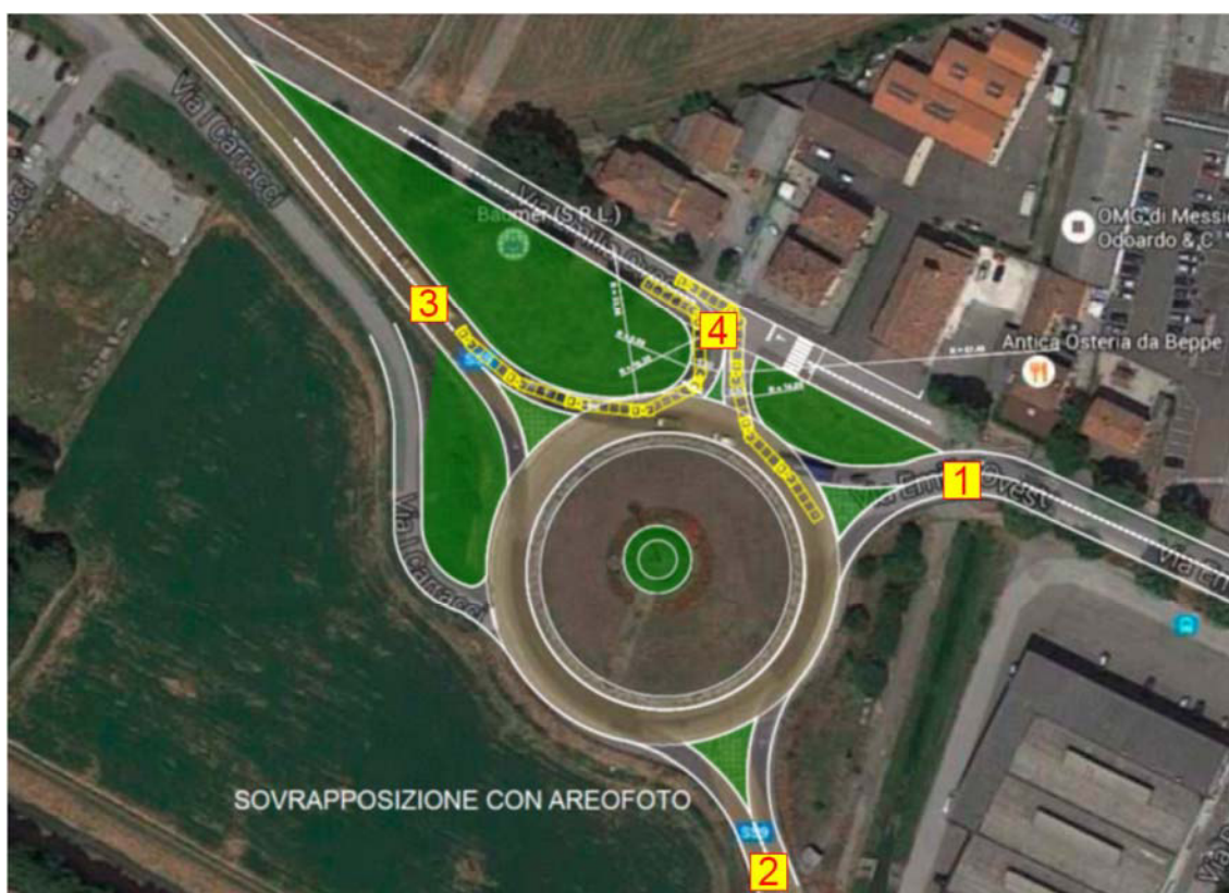
Img. 5.3 - Configurazione della rotatoria con le modifiche previste per ottenere un accesso da sud-ovest all'ambito 50 ANP
