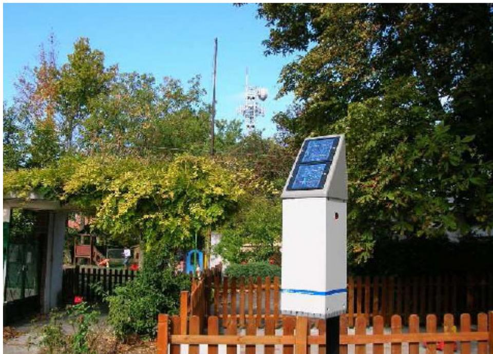
**RISULTATO DELLE MISURE IN CONTINUO:** Il valore di campo elettrico misurato nel periodo 19 settembre – 07 dicembre 2007 è risultato sempre inferiore alla minima sensibilità strumentale (0.3 V/m)
